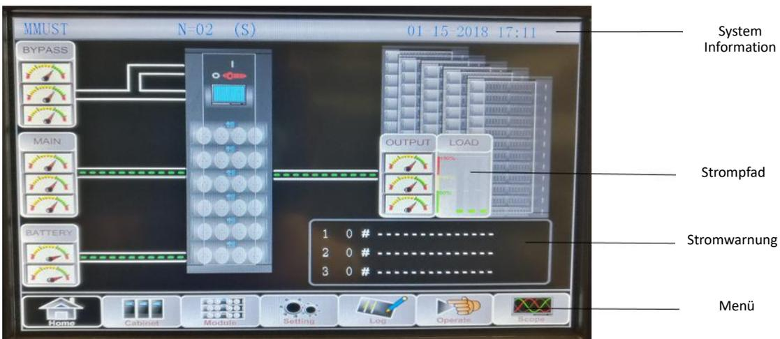
Abb.7- 2 : Haupt-LCD-Display
