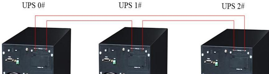
**Fig. 2-4:** Système avec 3 UPS en Parallèle
