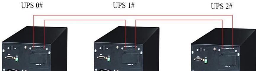
**Abb. 2-78:** System mit 3 parallel geschalteten USV
