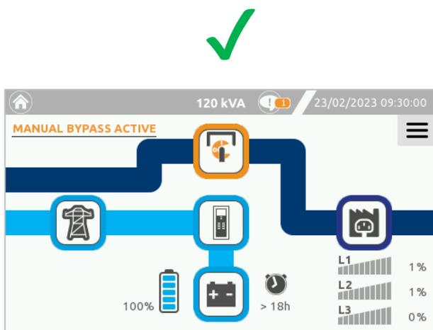
Die Bypass-Leitung wird durch eine gefüllte blaue Linie dargestellt. In diesem Zustand ist es möglich, den manuellen Bypass-Schalter zu öffnen.
