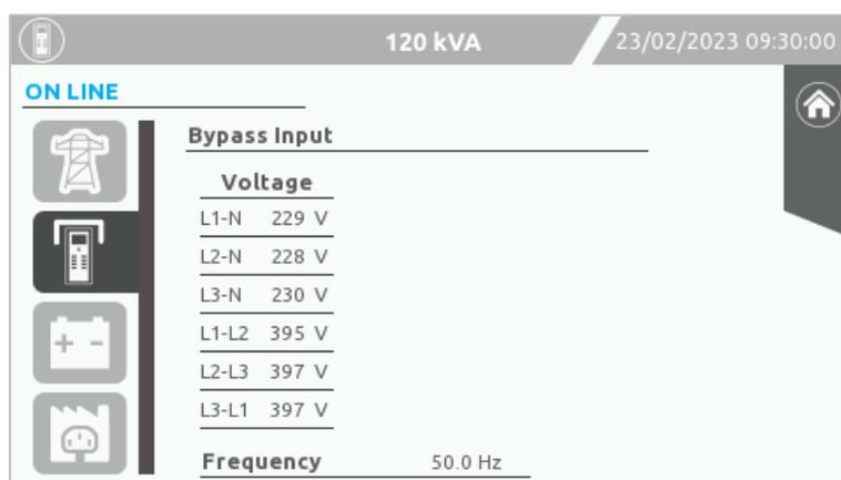
Die Seite „Bypass Eingang“ zeigt den Status und die Parameter der Bypass-Leitung der USV an.
