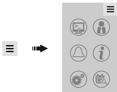
Berührungssensitive Symbole zum Erweitern bzw. Reduzieren des Menüs. Nach einigen Sekunden wird das Menü automatisch eingeklappt. Die Ansicht kann je nach dem eingestellten Benutzerlevel variieren.
