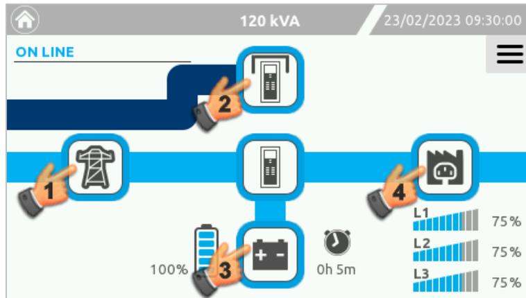
Durch Tippen auf eines der vier Auswahlensymbole für Eingang (1), Bypass (2), Batterie (3), Ausgang (4) wird die Seite mit den entsprechenden Messwerten geöffnet.
