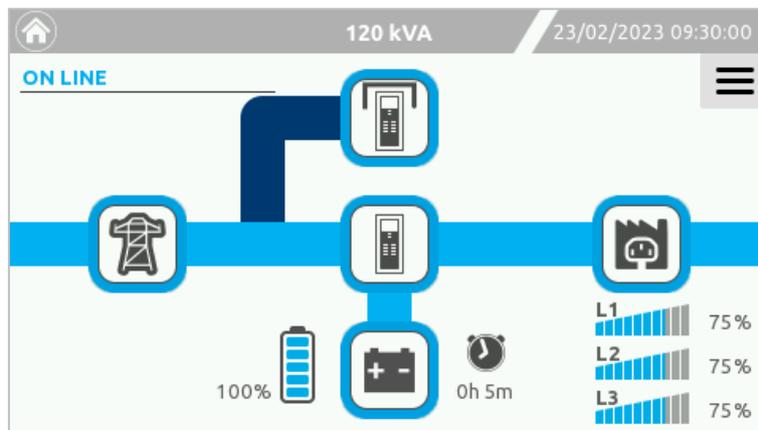
USV im ONLINE Betrieb (Normalbetrieb, Last an Wechselrichter).
