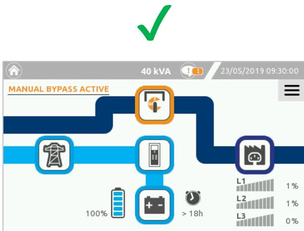
*La ligne bypass est représentée avec une ligne bleue pleine. Dans ce cas, il est possible d'ouvrir l'interrupteur de bypass manuel.*
