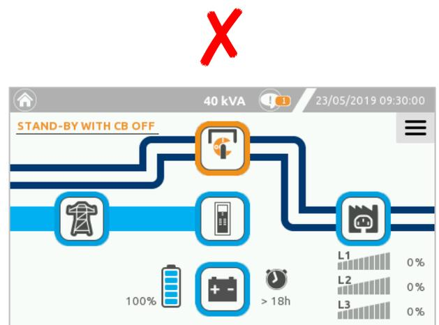
La línea bypass se representa mediante una raya blanca. En esta condición, no abra el seccionador bypass manual: la carga se perderá.
