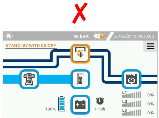
*La ligne bypass est représentée avec une ligne blanche. Dans ce cas, ne pas ouvrir l'interrupteur de bypass manuel : la charge sera perdue.*
