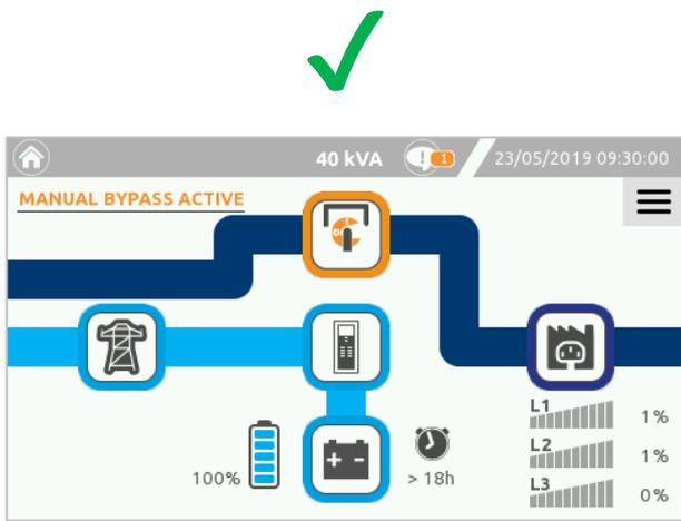
La línea bypass se representa mediante una línea azul llena. En esta condición, se puede abrir el seccionador bypass manual.
