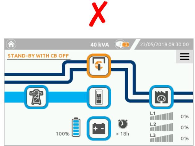
Die Bypass-Leitung wird als weißer Streifen dargestellt. Den manuellen Bypass-Schalter in diesem Zustand nicht öffnen: Die Lastversorgung geht sonst verloren.
